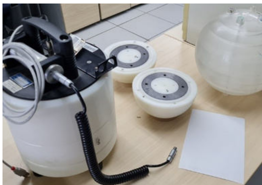
Figura 5 - Medidores de nêutrons da radiação cósmica que podem ser usados no interior de aeronaves em voo.
