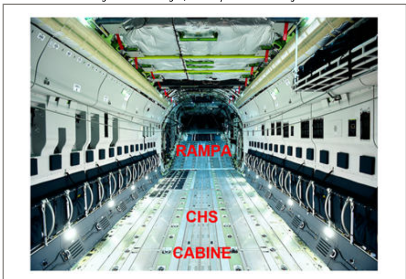
Figura 11 - Cabine, CHS e Rampa - Sistema de Manuseio de Cargas: tem a função de prover o carregamento de cargas, a retenção e o descarregamento.
