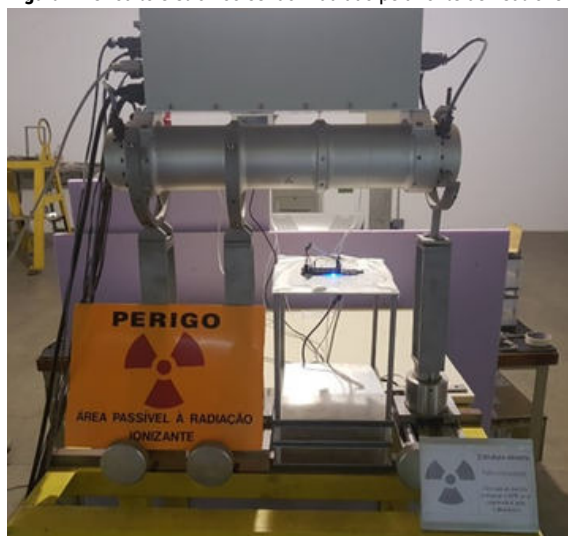
Figura 4 - Circuito eletrônico sendo irradiado pela fonte de nêutrons.
